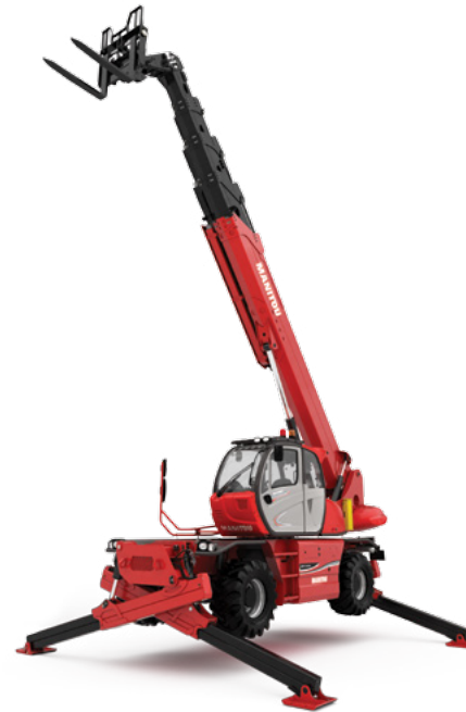
Rotation sur stabilisateurs déployés avec treuil 5000 kg
