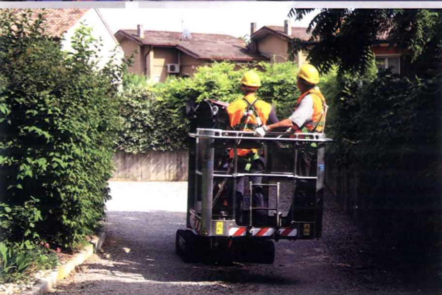
Über das innovative, in der Standardausstattung vorhandene Auto2Speed Antriebssystem wird eine Fahrgeschwindigkeit von bis zu max. 3,6 km/h erreicht, was doppelt so schnell ist wie die derzeit am Markt übliche Geschwindigkeit.
