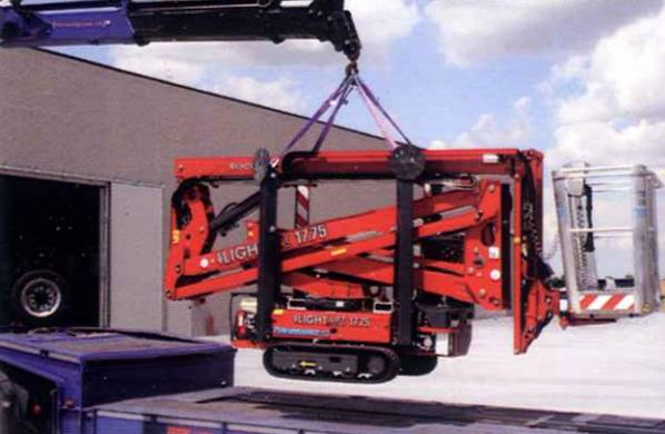
Es ist auch möglich, die Maschine mittels eines Krans an den dafür vorgesehenen neuen Ösen auf Transportfahrzeuge auf- und von diesen wieder abzuladen.
