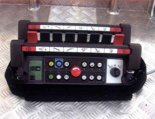
Die Steuerung der Abstützaomatik, Armbewegung und Raupen-Fortbewegung wird einfach und bequem über die PERFORMANCE III S - Fernbedienung ausgeführt. Ein praktisches Display liefert dem Bediener wichtige Informationen. Zusätzlich wurde das System um neue Parameter erweitert. Über das Download-Symbol kann die jeweils letzte für die Maschine verfügbare Softwareversion über das integrierte Modem direkt vom Bediener heruntergeladen werden.
