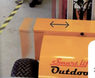
Der SL 380 Outdoor ist bis zu 100 mm seitverschiebbar zur Feinjustierung beim Fenstereinbau.
