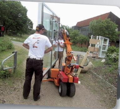
Die Maschine ist standardmäßig für die Fenster- und Glasmontage ausgelegt, kann aber auch mit Spezialvorrichtung zum Hantieren von beispielsweise schweren Brandschutztüren und Toren geliefert werden.
