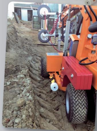
Die Leistung des Motors beträgt 1200 W und der Motor ist mit einer elektronischen Bremse ausgestattet. Selbst bei einer Last von 380 kg ist die Motorkraft für den Betrieb im Freien im Gelände großzügig dimensioniert.
