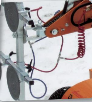
Das Vakuumsystem des Lifts ist in zwei separate Kreise unterteilt, für höchste Sicherheit. Hier sind Vakuumpumpen mit blauen bzw. roten Vakuumschläuchen zu sehen.
