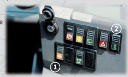
② - Die elektrohydraulische Kabinenanhebung erlaubt einen uneingeschränkten und schnellen Zugriff auf alle Komponenten bei der Wartung.
